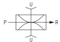
P=CONNESSIONE ARIA COMPRESSA R=SCARICO U=CONNESSIONE VUOTO U 1-2-3=CONNESSIONE VUOTO SUPPLEMENTARE
